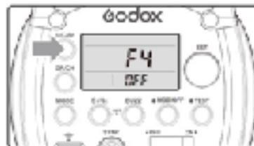
**3** Über das Wahlrad ändern Sie die Werte, mit Druck auf die SET-Taste werden diese bestätigt.
